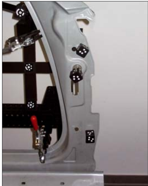
Fixinspect PG Messhilfsadapter im Einsatz
