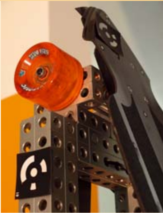
Bild 2 Die als Referenzpunkte dienenden Targets werden im vorliegenden Fall sowohl auf dem Werkstück als auch auf der Vorrichtung platziert
