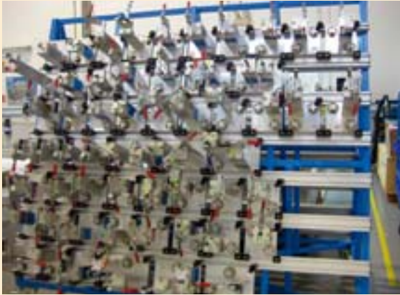
Lagerplatz für Megalu-Säulen. Jede einzelne Säule befindet sich auf einer kleinen Grundplatte, die mit einem Schnellwechselmechanismus (PWS – Precision Witte System) versehen ist. Somit können die Säulen bei Bedarf schnell auf der Sandwichplatte eingesetzt werden.
