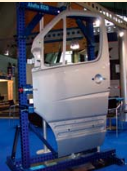
Alufix Eco-Vorrichtung mit Fahrzeug-Tür. Das System wurde erstmals auf der Control 2010 in Stuttgart vorgestellt.
