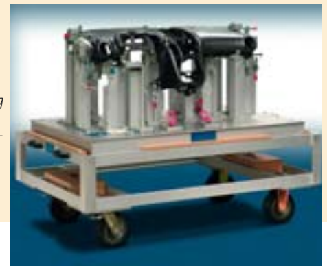
Pkw-Instrumententafel auf Megalu-Vorrichtung mit Transport-Trolley. Die Megalu-Säulen wurden auf eine Sandwichplatte montiert.
