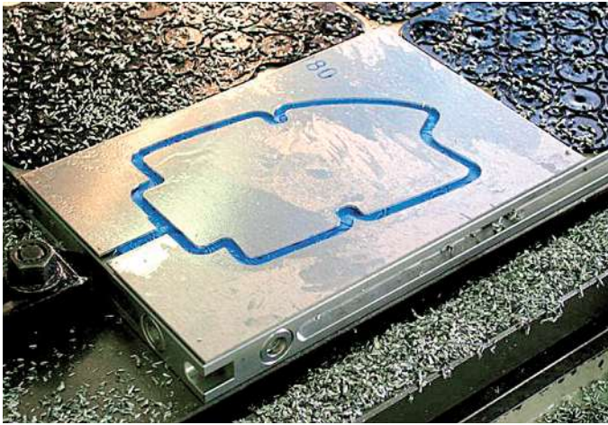
Bild 8: Vac-Mat-Platten im Standardformat 200 mm × 300 mm; das Werkstück wurde komplett herausgefräst.
