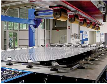
Bild 1: Gesteuerte Vakuum-Spannvorrichtung mit automatischer Andrückvorrichtung für großformatige Aluminiumbleche.
