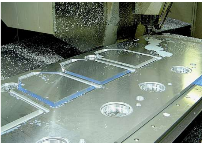
Bild 6: Zum Bearbeiten großflächiger Bauteile wurden mehrere Vac-Mat-Platten zusammengefügt.
