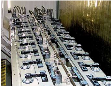
Bild 2: Hochlegierte Stahlbleche werden auf einer Sonder-Vakuumvorrichtung für Fräs- und Bohrbearbeitung gespannt.
