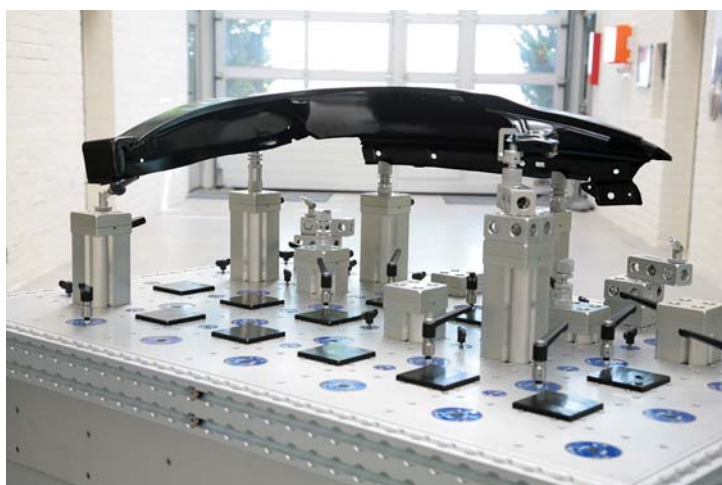
Foto A49: horizontale Sandwichplatte mit aufgenommenem Bauteil
