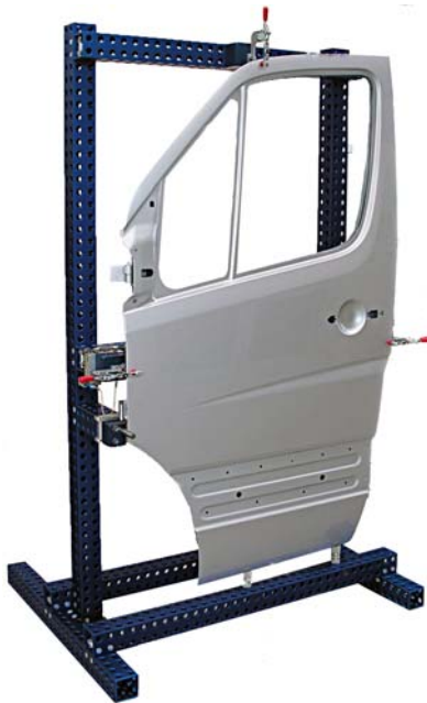
Foto links: Alufix ECO-Vorrichtung mit Pkw-Seitentür. Durch die blaue Farbgebung ist es leicht vom Alufix Classic-System zu unterscheiden.
